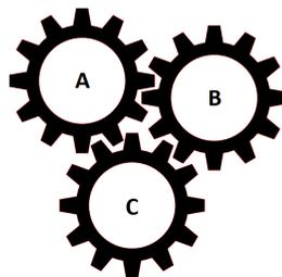
Para resolver esse problema, basta desengatar as engrenagens B e C que o sistema volta a funcionar; como mostra a figura abaixo.
